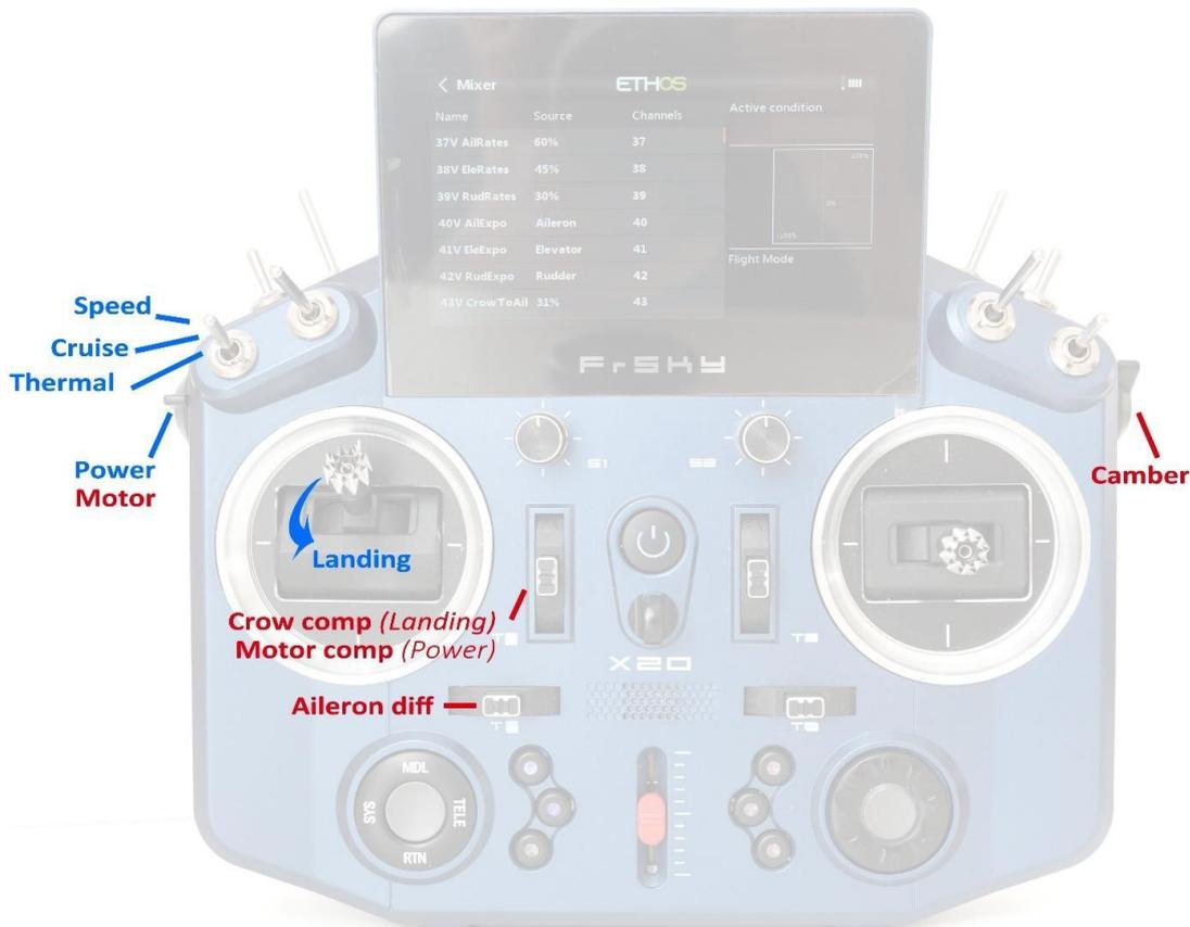
Anordnung der E-Soar Plus-Bedienelemente (Abbildung: Modus 2)
